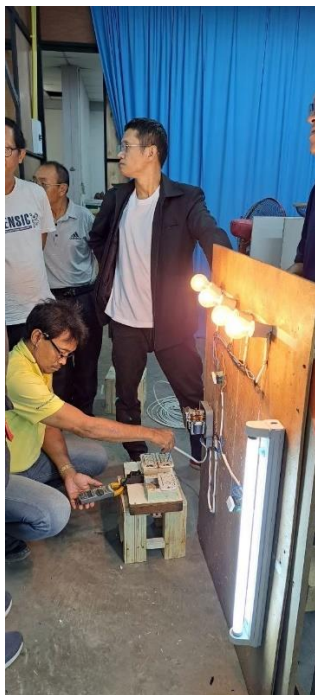
รูปแสดงการต่อวงจรไฟฟ้าแบบผสม
